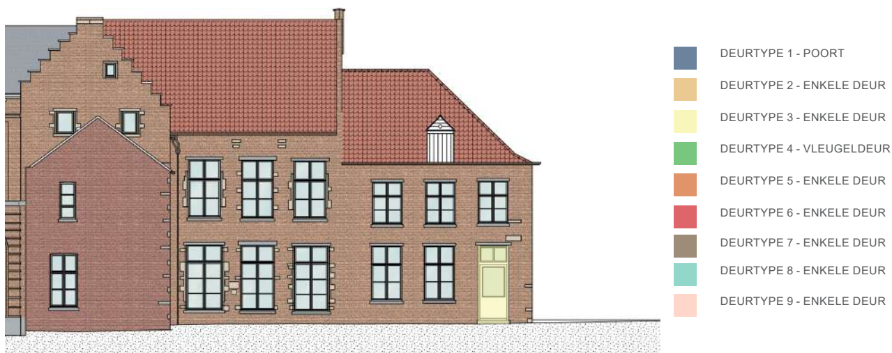
ZUIDOOSTGEVEL - INVENTARIS DEUREN
