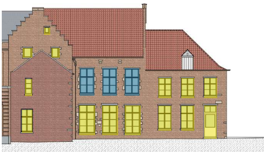
ZUIDOOSTGEVEL - WAARDESTELLING BUITENSCHRIJNWERK
