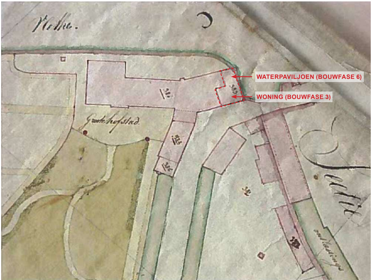
DETAIL VAN HET PRIMITIEF KADASTERPLAN OMSTREEKS 1830 MET AANDUIDING WATERPAVILJOEN DAT INTERN VERBONDEN IS MET DE DERDE BOUWFASE MAAR NIET MET DE PANDEN LINKS VAN HET PAVILJOEN. (BRON: ARCHIEF VAN HET KADASTER TE ANTWERPEN)
