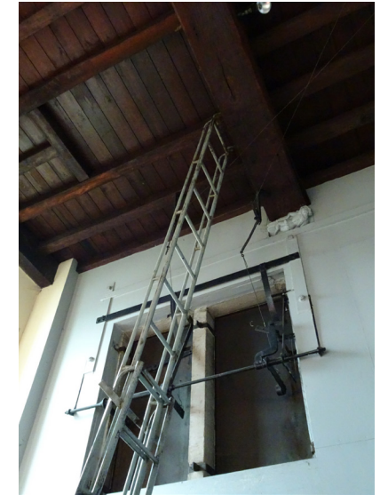
Afbeelding 106. Het moederhorloge stuurt het slagwerk aan en ladder naar de zolderverdieping.
